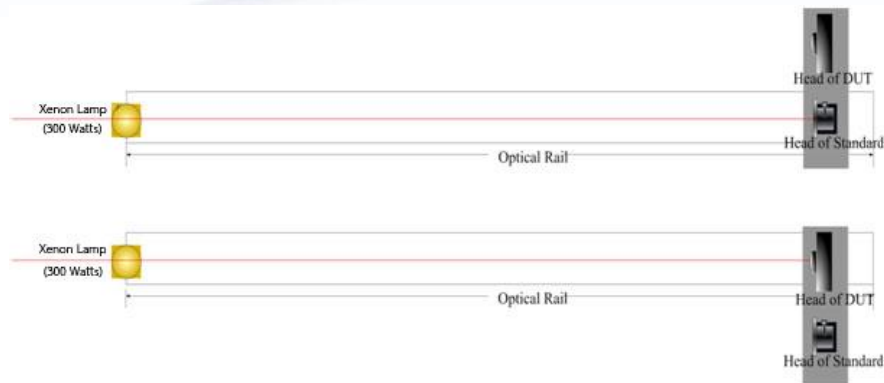
รูปที่ 2 แสดงการติดตั้งหัววัดแสง
