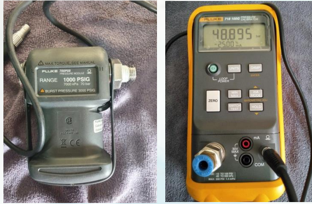
รูปที่ 13 UUC (Pressure module \pm 1\% of FS. , Pressure calibrator \pm 0.025\% of FS)
