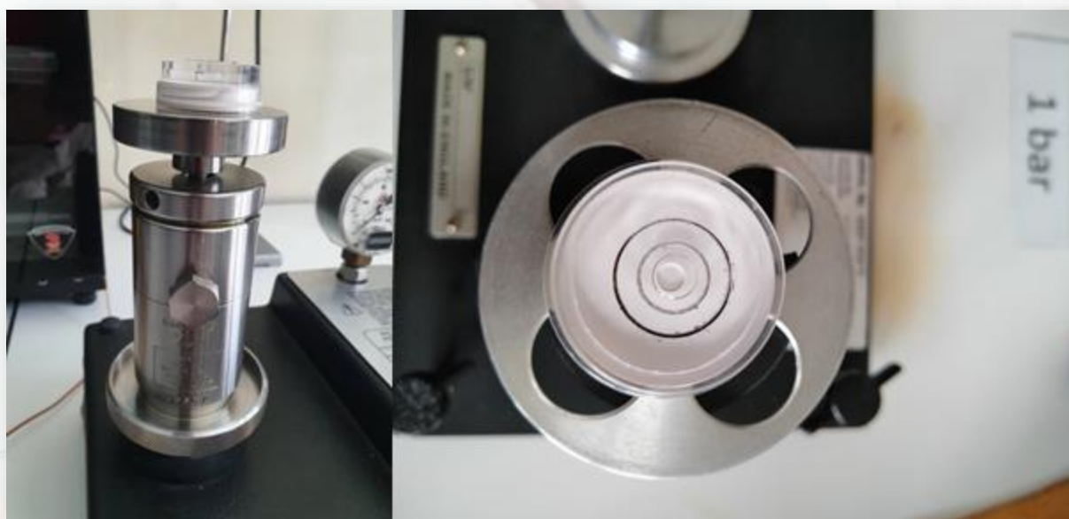
รูปที่ 5 ปรับขาตั้ง Foot ของ STD ให้ Spirit Level ตั้งฉากกับแนวระดับ
