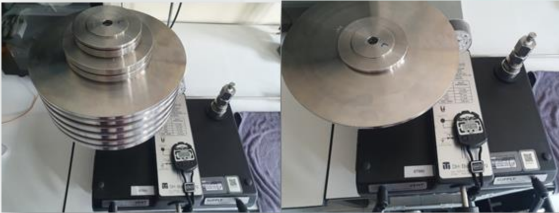
รูปที่ 16 การทำ Verification Pneumatic DWT 120 bar, PCU No. 530K
