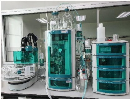
รูปที่ 4 ภาพแสดงเครื่อง Ion Chromatography (IC)
